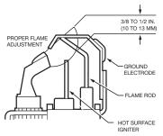
NOTE: GROUND ELECTRODE MUST NOT TOUCH FLAME ROD (.050 IN. MINIMUM CLEARANCE). BEND GROUND ELECTRODE IF NECESSARY. DO NOT BEND FLAME ROD.
